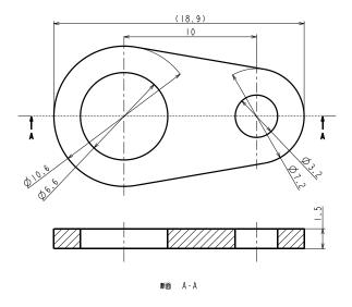
アンテナ固定具外形寸法図(参考)
